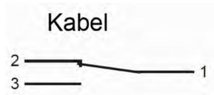
Zustand des Kontaktes bei Gerät ohne Durchfluss
