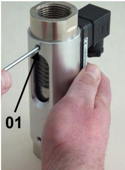
**Abb. 34: Schrauben lösen**
