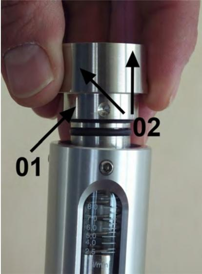
Abb. 49: Verschraubung (Ausgang) in Gerätehülse einsetzen
