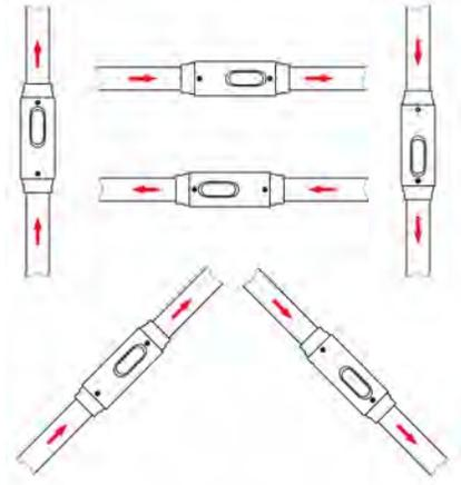
Abb. 5: Einbauposition/Durchflussrichtung
