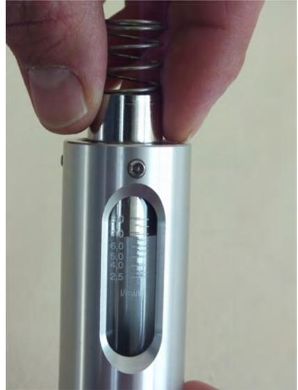
Abb. 48: Schwebekörper und Innenteile einführen
