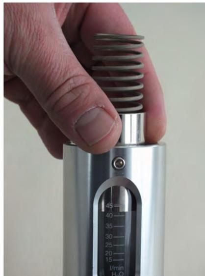
*Abb. 48: Schwebekörper und Innenteile einführen*
