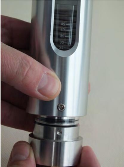
Abb. 45: Verschraubung in Gerätehülse schieben
