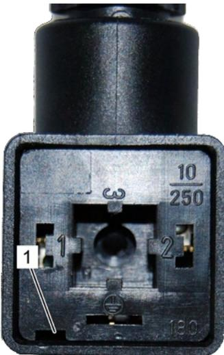
Abb. 22: Innenteil lösen
