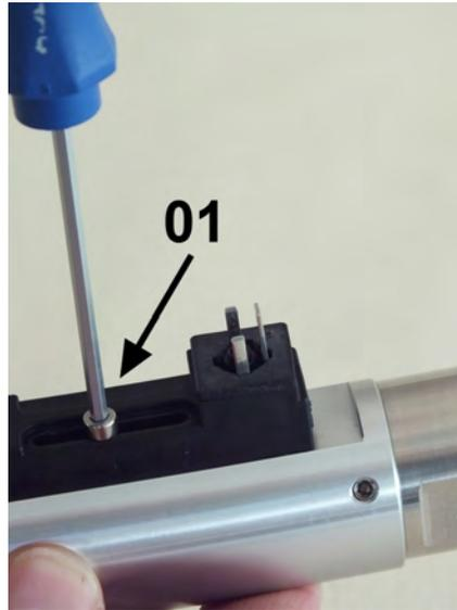
Abb. 54: Feststellschraube lösen
