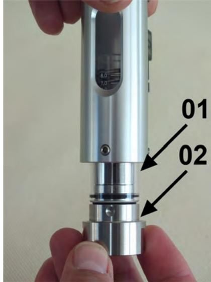
Abb. 37: Innenteile herausziehen
