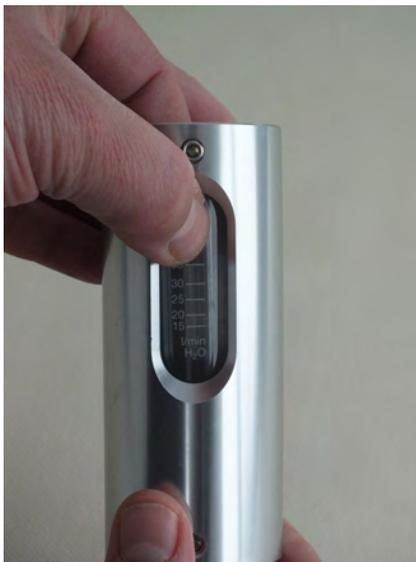
*Abb. 47: Schauglas ausrichten*
