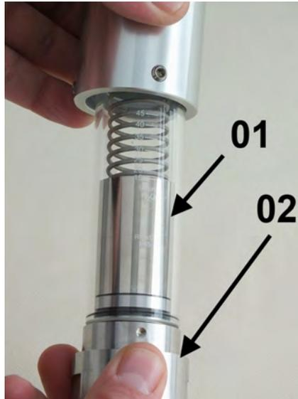
Abb. 37: Innenteile herausziehen
