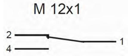
Abb. 19: Zustand des Kontaktes bei Gerät ohne Durchfluss
