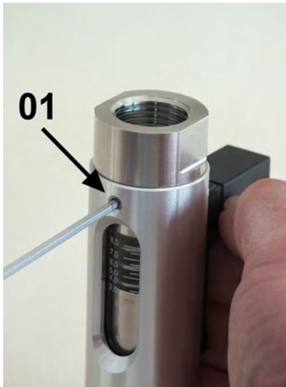
*Abb. 34: Schrauben lösen*
