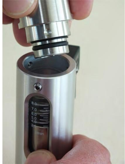
*Abb. 35: Verschraubung (Ausgang) abnehmen*
