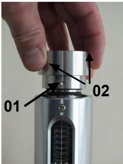
Abb. 49: Verschraubung (Ausgang) in Gerätehülse einsetzen
