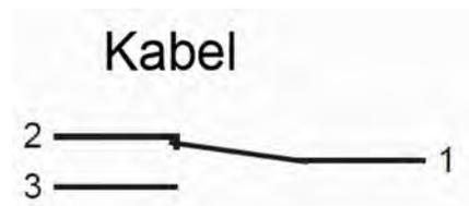
Zustand des Kontaktes bei Gerät ohne Durchfluss
