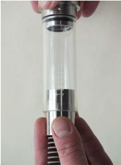
Abb. 38: Schwebekörper, Magnete und Feder entnehmen
