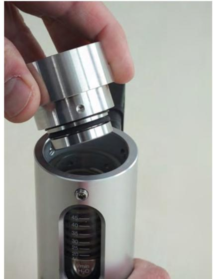
**Abb. 35: Verschraubung (Ausgang) abnehmen**
