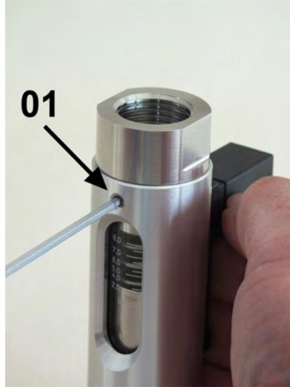
Abb. 50: Innensechskantschrauben anziehen
