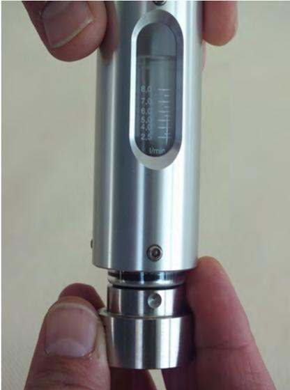
Abb. 45: Verschraubung in Gerätehülse schieben
