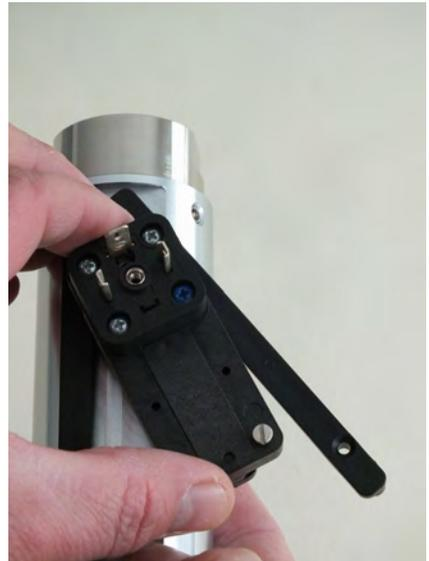
*Abb. 56: Führungsleiste wegklappen*
