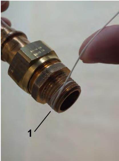
Abb. 9: Dichtfaden aufbringen
