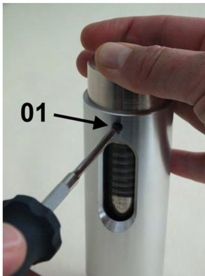
Abb. 50: Innensechskantschrauben anziehen
