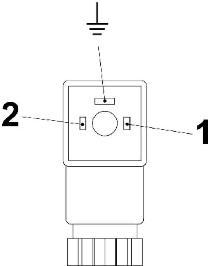
Abb. 14: Pin-Belegung Steckerdose Schließer (Erde-Anschluss nicht genutzt)
