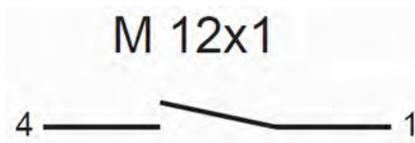
Abb. 18: Zustand des Kontaktes bei Gerät ohne Durchfluss
