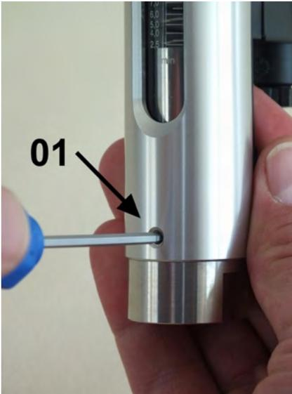
Abb. 36: Schrauben lösen
