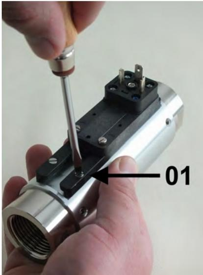
*Abb. 55: Führungsleiste lösen*
