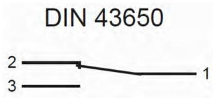
Abb. 15: Zustand des Kontaktes bei Gerät ohne Durchfluss
