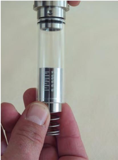
Abb. 38: Schwebekörper, Magnete und Feder entnehmen
