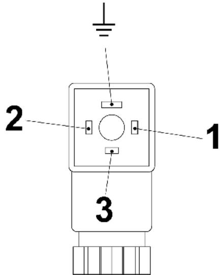
Abb. 16: Pin-Belegung Steckerdose Wechsler (Erde-Anschluss nicht genutzt)
