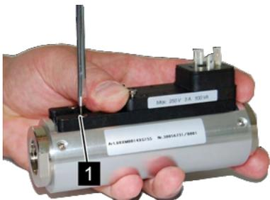
Abb. 60: Führungsleiste lösen
