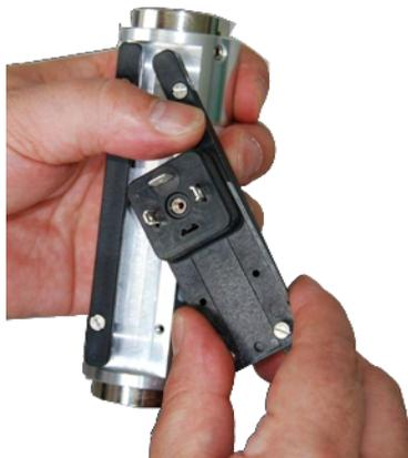
Abb. 61: Führungsleiste wegklappen
