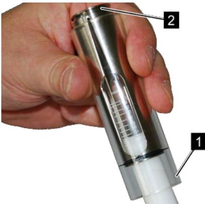
Abb. 44: Schlitzdüse durchschieben
