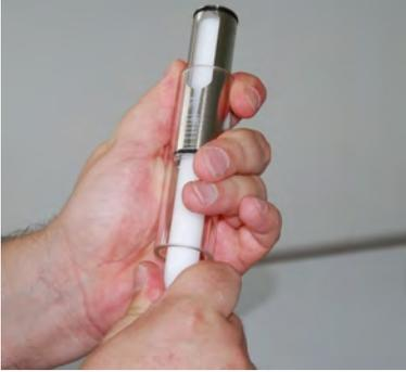
Abb. 39: Schlitzdüse entnehmen
