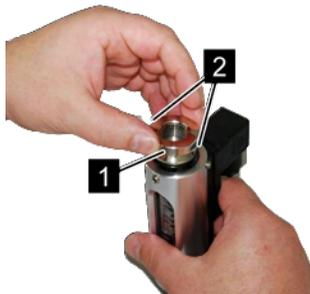
Abb. 54: Verschraubung (Ausgang) einsetzen
