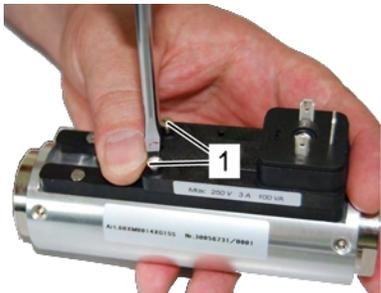
Abb. 59: Feststellschrauben lösen
