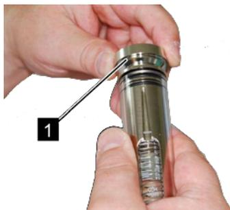
Abb. 48: Verschraubung (Eingang)
