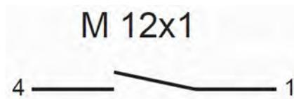
Abb. 18: Zustand des Kontaktes bei Gerät ohne Durchfluss
