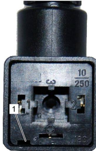
Abb. 22: Innenteil lösen
