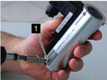
Abb. 37: Schrauben lösen
