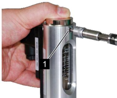
Abb. 55: Innensechskantschrauben anziehen
