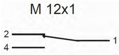
Abb. 19: Zustand des Kontaktes bei Gerät ohne Durchfluss
