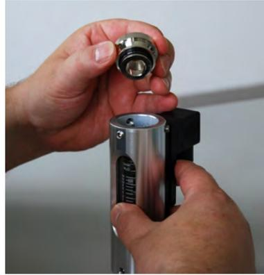
Abb. 35: Verschraubung (Ausgang) abnehmen
