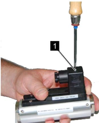
Abb. 20: Steckerdose lösen
