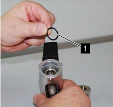
Abb. 36: O-Ring Schlitzdüsenpuffer
