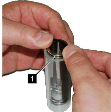
Abb. 45: Schlitzdüsenzentrierung
