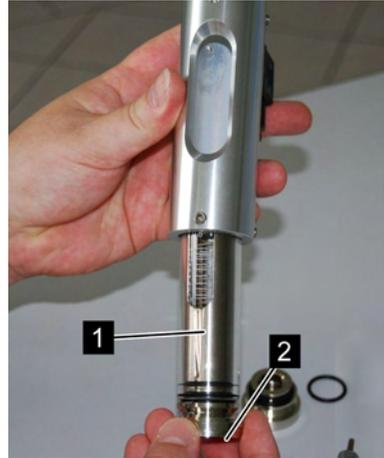
Abb. 38: Innenteile herausziehen
