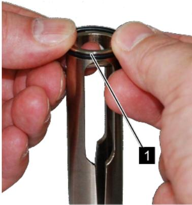
Abb. 43: O-Ring (Schlitzdüsenzentrierung)
