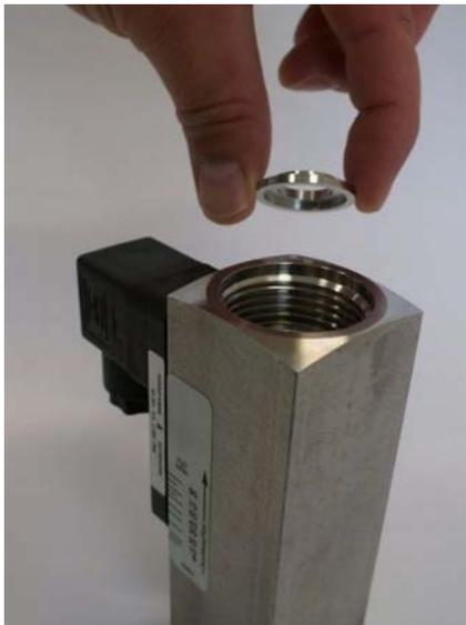
*Fig. 46: Insert centering disc (outlet)*
