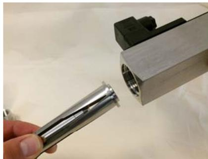
Fig. 46: Insert inner parts
