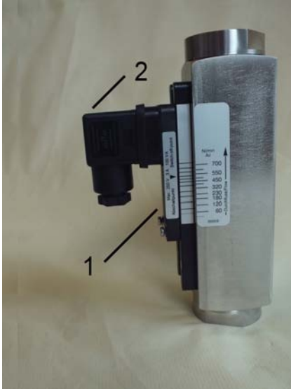
Abb. 3: Schaltkontakt und Steckerdose
