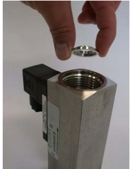
Abb. 46: Zentrierscheibe (Ausgang) einführen
