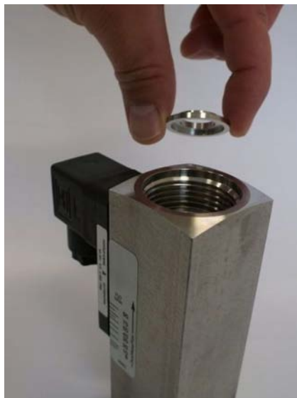
Abb. 35: Zentrierscheibe entnehmen (Ausgang)
