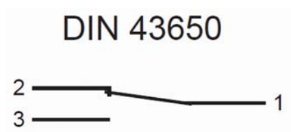
Abb. 15: Zustand des Kontaktes bei Gerät ohne Durchfluss
