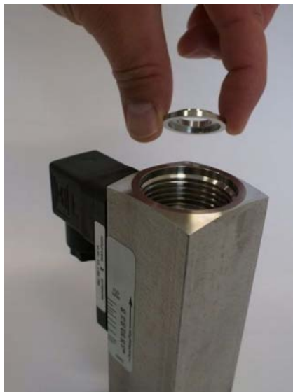
Abb. 36: Zentrierscheibe entnehmen (Ausgang)
