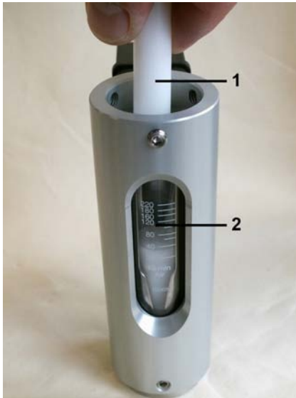
Fig. 50: Align slot nozzle
