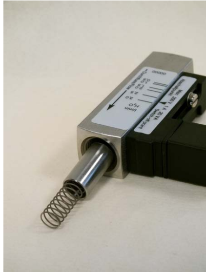
Fig. 37: Remove inner parts
