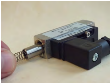
Fig. 37: Remove inner parts
