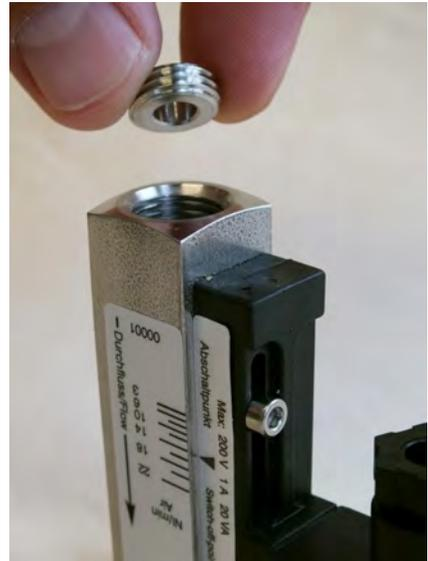
Abb. 41: Gewinding (Eingang) entnehmen
