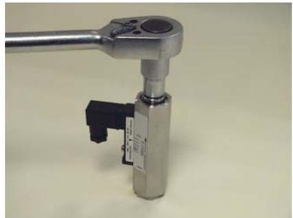
Abb. 50: Gewinding (Ausgang) festziehen
