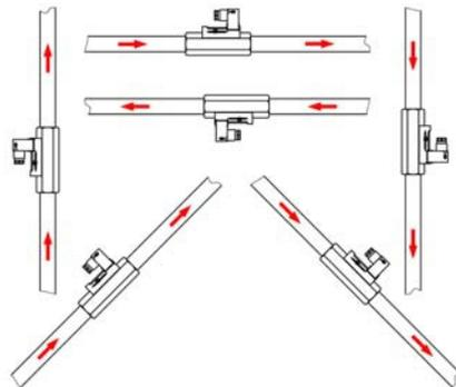
Abb. 5: Einbauposition/Durchflussrichtung
