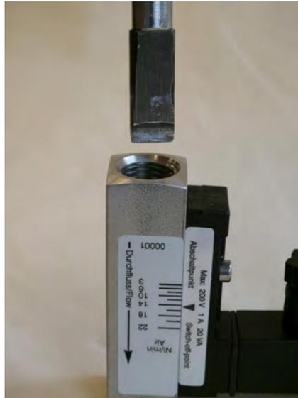
Abb. 39: Eindreihwerkzeug Gewindering (Eingang) einführen
