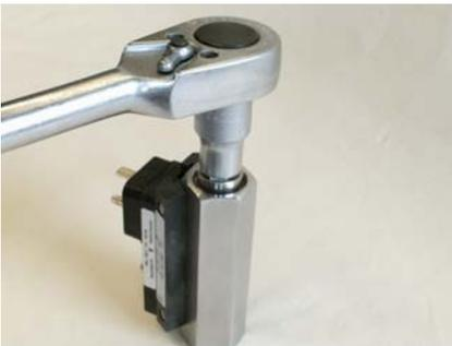
Abb. 41: Gewinding (Ausgang) festziehen
