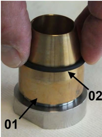
Abb. 46: O-Ring (Dichtung)
