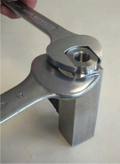
Abb. 51: Verschraubung (Eingang) festziehen
