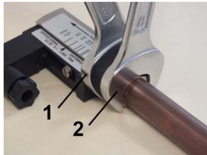
Abb. 11: Gerät einschrauben
