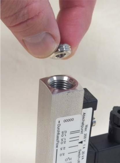
Abb. 41: Gewinding (Eingang) entnehmen
