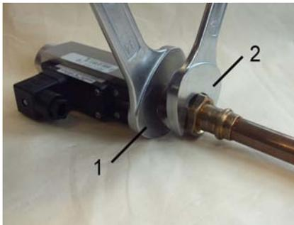
Abb. 10: Gerät einschrauben
