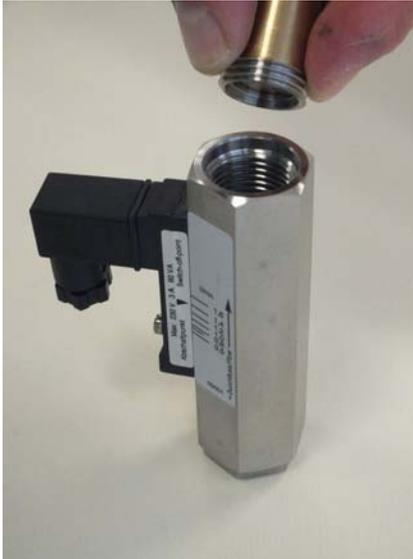
Abb. 38: Gewinding (Ausgang) entnehmen
