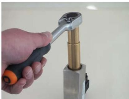
Abb. 43: Gewinding (Eingang) lösen
