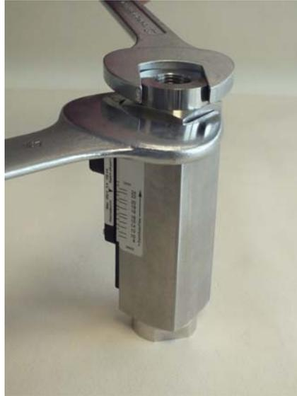
Abb. 33: Verschraubung (Ausgang) lösen
