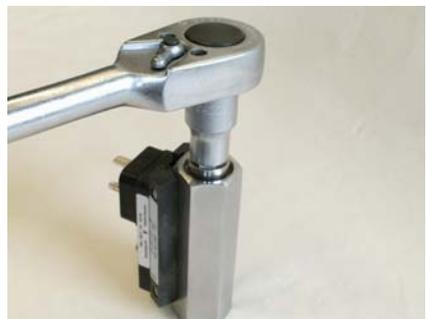
Abb. 34: Gewinding (Ausgang) lösen
