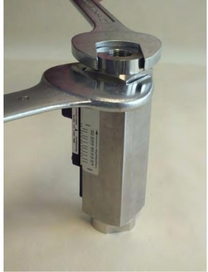
Abb. 57: Verschraubung (Ausgang) festziehen
