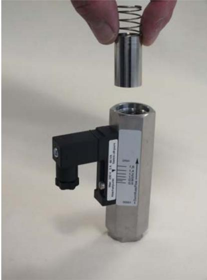
Abb. 48: Innenteile einführen
