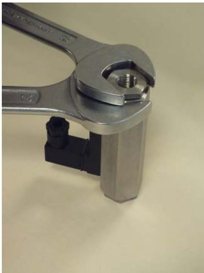
Abb. 46: Verschraubung (Eingang) festziehen
