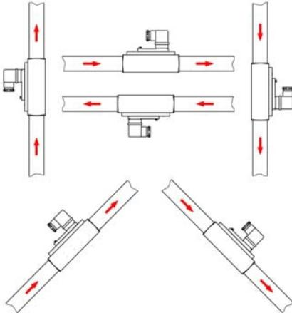
Abb. 5: Einbauposition/Durchflussrichtung
