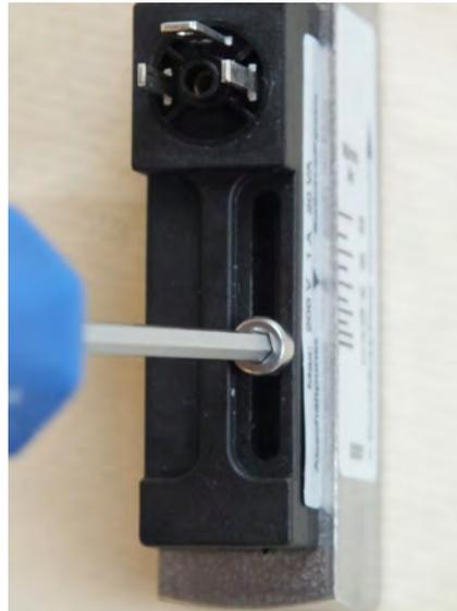
Abb. 31: Feststellschraube lösen
