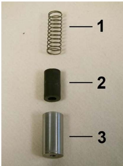
Abb. 38: Feder, Magnete und Schwebekörper
