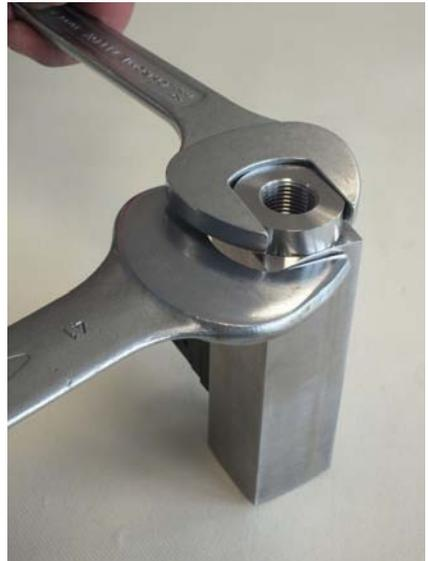
Abb. 40: Verschraubung (Eingang) lösen
