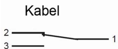
Zustand des Kontaktes bei Gerät ohne Durchfluss
