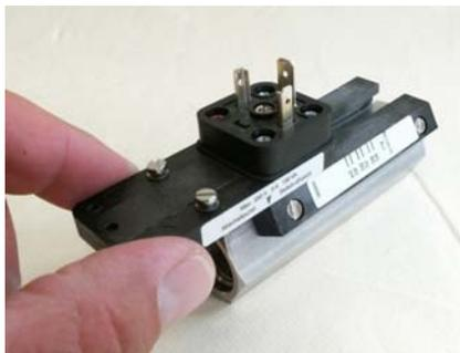
Abb. 46: Schaltkontakt aus Führung schieben
