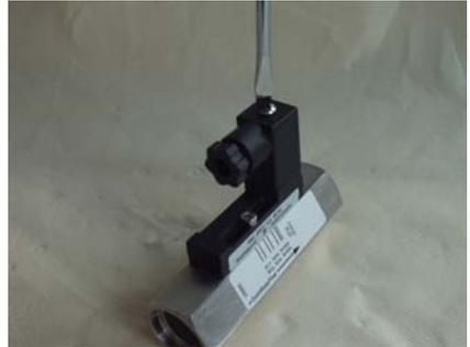
Abb. 54: Steckerdose lösen
