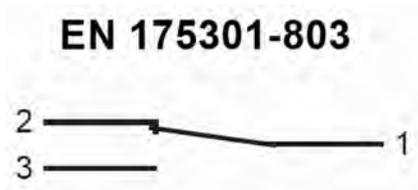
Abb. 14: Zustand des Kontaktes bei Gerät ohne Durchfluss
