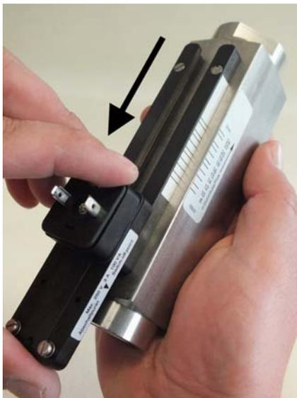
Abb. 61: Schaltkontakt aus Führung schieben
