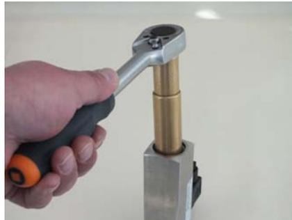
Abb. 48: Gewinding (Eingang) festziehen
