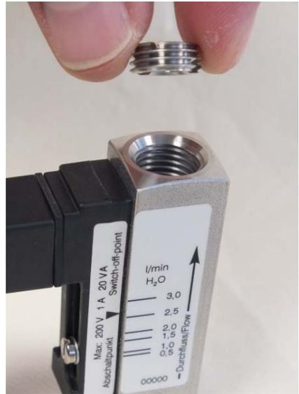
Abb. 36: Gewinding (Ausgang) entnehmen
