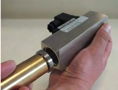
Abb. 48: Gewinding (Eingang) einführen
