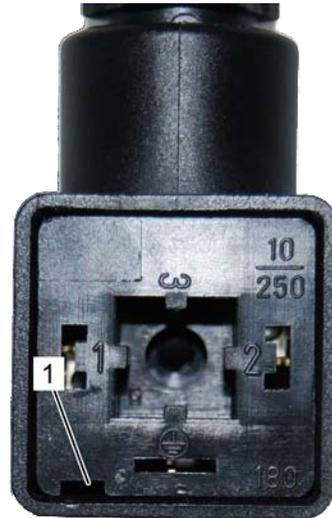
Abb. 21: Innenteil lösen
