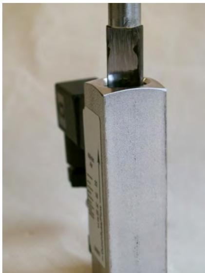
Abb. 47: Gewinding (Ausgang) festziehen
