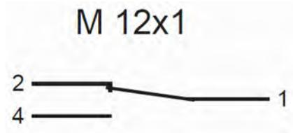
Abb. 18: Zustand des Kontaktes bei Gerät ohne Durchfluss
