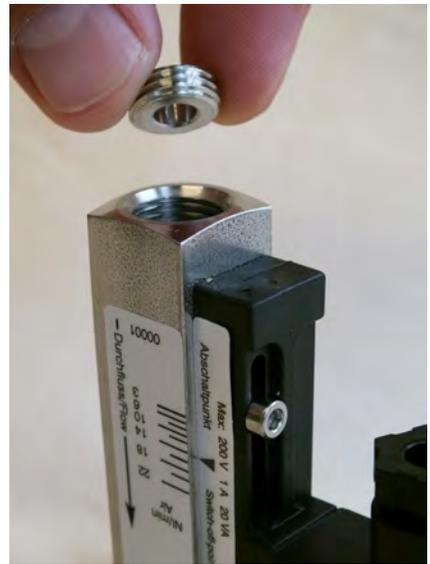
Abb. 42: Gewinding (Eingang) einführen
