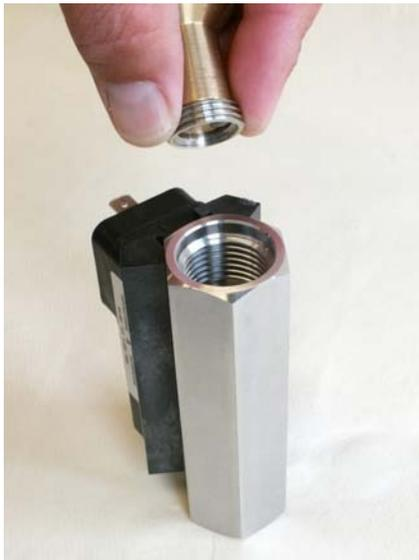
Abb. 35: Gewinding (Ausgang) entnehmen
