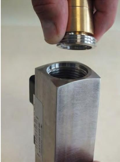
Abb. 38: Gewindering (Ausgang) entnehmen
