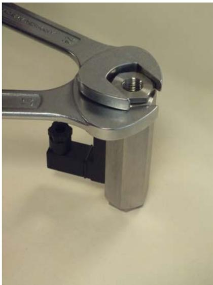
Abb. 41: Verschraubung (Eingang) lösen
