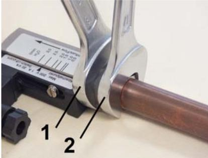
Abb. 12: Gerät einschrauben
