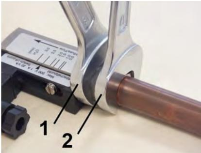
Abb. 11: Gerät einschrauben
