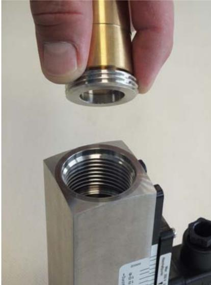
Abb. 44: Gewinding (Eingang) entnehmen
