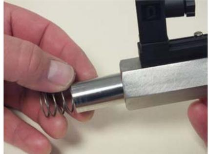
Abb. 39: Innenteile entnehmen
