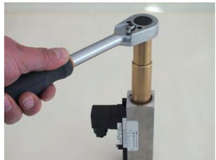
Abb. 55: Gewinding (Ausgang) festziehen
