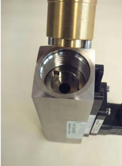
Abb. 43: Eindrehwerkzeug Gewindering (Eingang) einführen
