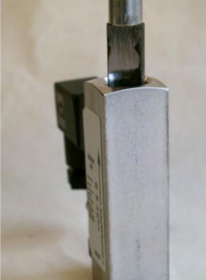
Abb. 35: Gewinding (Ausgang) lösen
