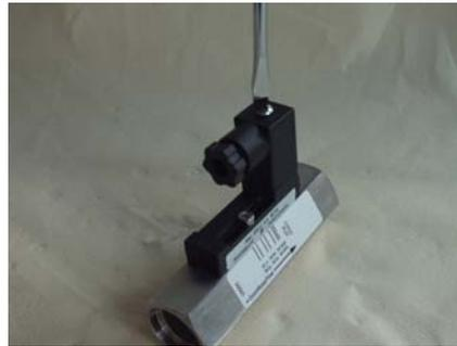
Abb. 20: Steckerdose lösen
