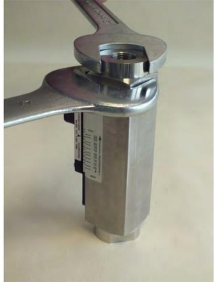
*Abb. 34: Verschraubung (Ausgang) lösen*
