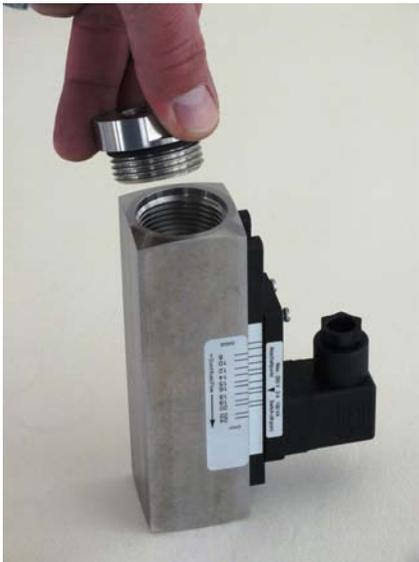
Abb. 41: Verschraubung (Eingang) abnehmen
