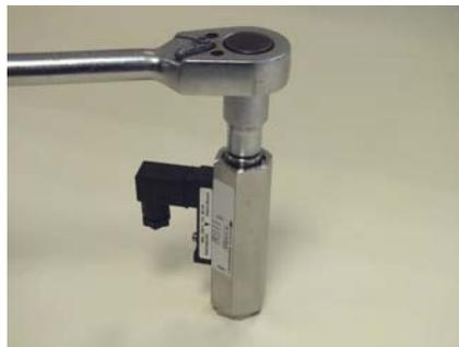
Abb. 37: Gewinding (Ausgang) lösen
