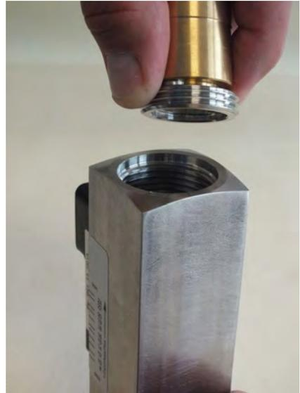
Abb. 45: Gewindering (Eingang) entnehmen
