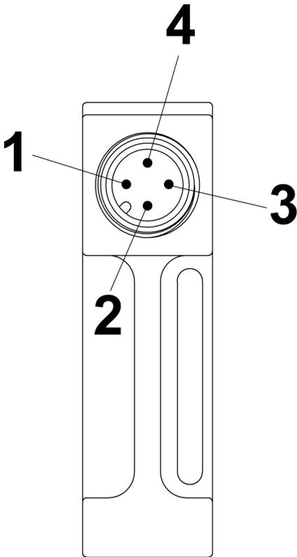
Abb. 16: Pin-Belegung Gerätestecker M12x1 (Form 15x50)
