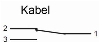
Zustand des Kontaktes bei Gerät ohne Durchfluss
