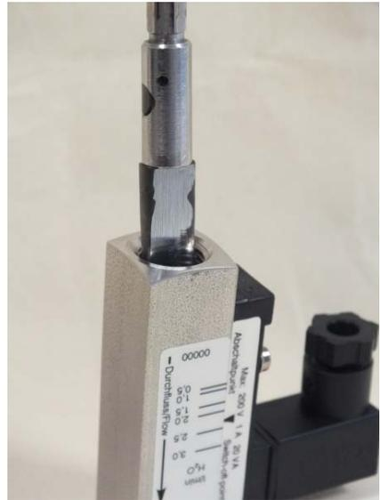
Abb. 40: Gewinding (Eingang) lösen
