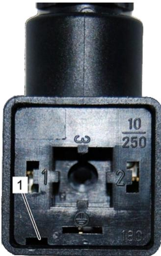
Abb. 22: Innenteil lösen
