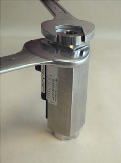
Abb. 56: Verschraubung (Ausgang) festziehen
