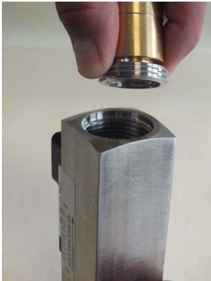
Abb. 37: Gewinding (Ausgang) entnehmen
