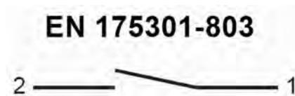
Abb. 12: Zustand des Kontaktes bei Gerät ohne Durchfluss
