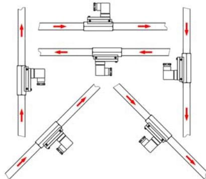
Abb. 5: Einbauposition/Durchflussrichtung
