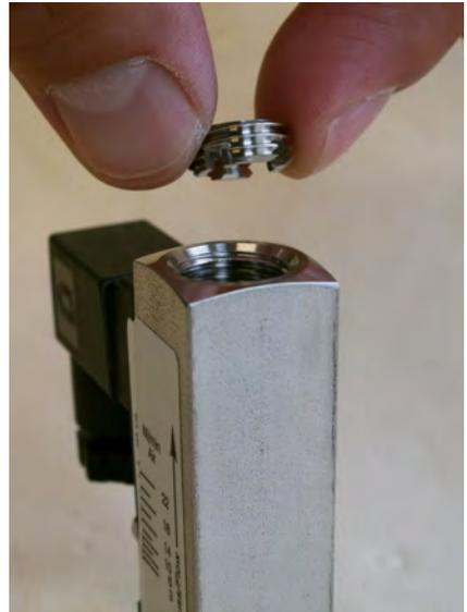
Abb. 46: Gewinding (Ausgang) einführen
