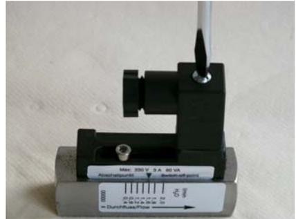
Abb. 49: Steckerdose lösen
