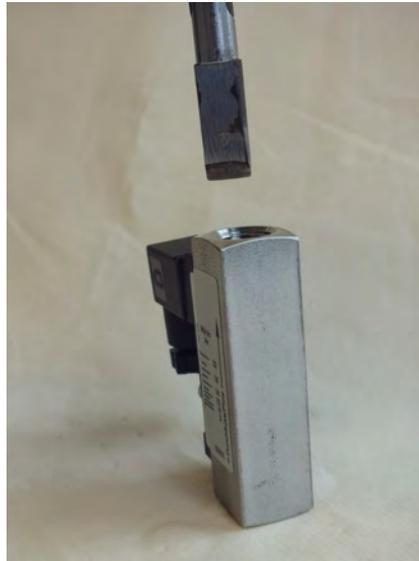
*Abb. 34: Eindrehwerkzeug-Gewinding einführen (Ausgang)*
