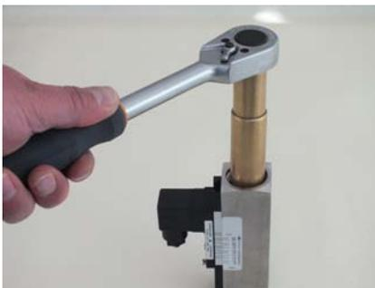
Abb. 54: Gewinding (Ausgang) festziehen
