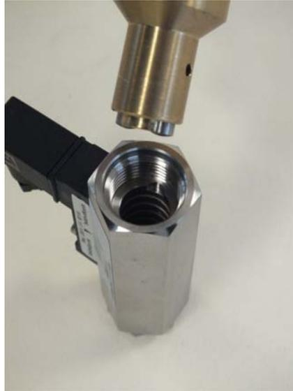
Abb. 36: Eindrehwerkzeug-Gewindering einführen (Ausgang)
