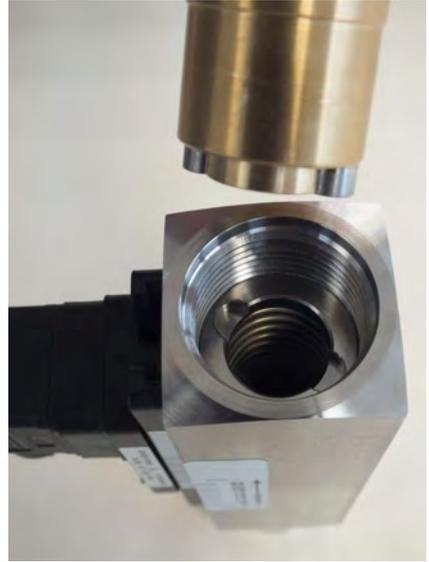
Abb. 36: Eindrehwerkzeug-Gewindering einführen (Ausgang)
