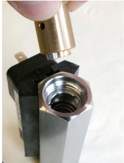
Abb. 33: Eindrehwerkzeug-Gewinding einführen (Ausgang)
