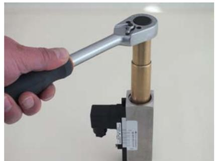
Abb. 36: Gewindering (Ausgang) lösen
