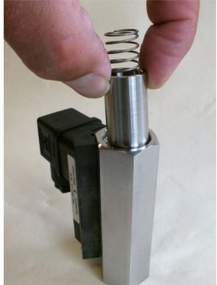
Abb. 39: Innenteile einführen
