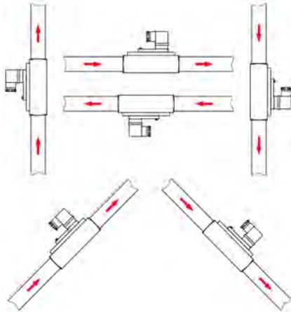
Abb. 5: Einbauposition/Durchflussrichtung
