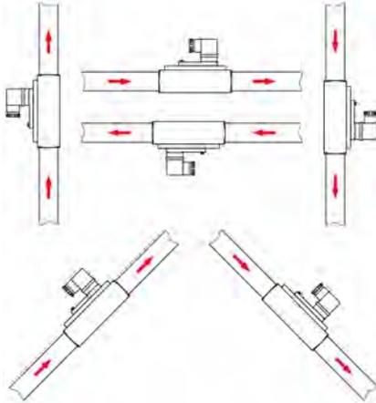
Abb. 5: Einbauposition/Durchflussrichtung
