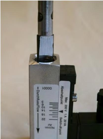
Abb. 43: Gewinding (Eingang) festziehen
