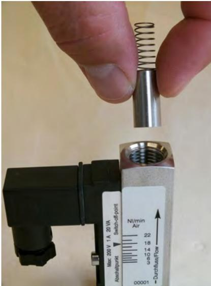
Abb. 45: Innenteile einführen
