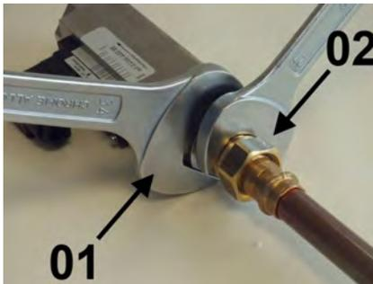
Abb. 11: Gerät einschrauben
