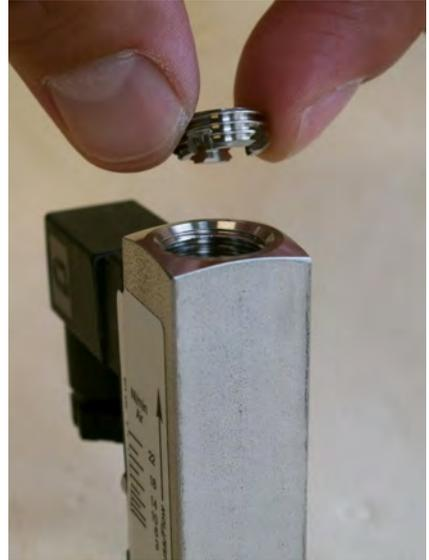
Abb. 36: Gewinding (Ausgang) entnehmen
