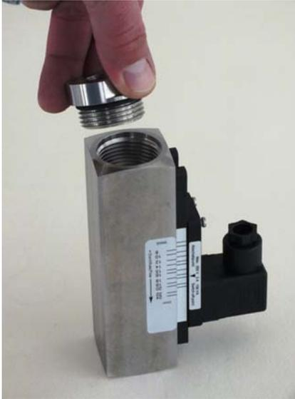
Abb. 49: Verschraubung (Eingang) einsetzen
