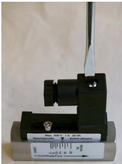
Abb. 49: Steckerdose lösen
