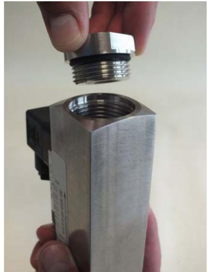
Abb. 55: Verschraubung (Ausgang) einsetzen
