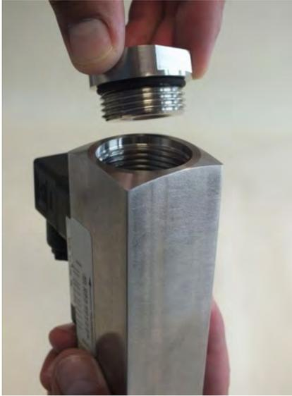
Abb. 35: Verschraubung (Ausgang) abnehmen
