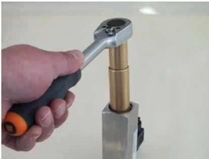
Abb. 49: Gewinding (Eingang) festziehen
