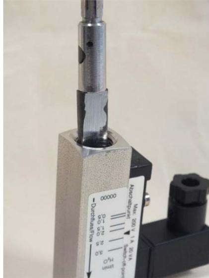
Abb. 43: Gewinding (Eingang) festziehen
