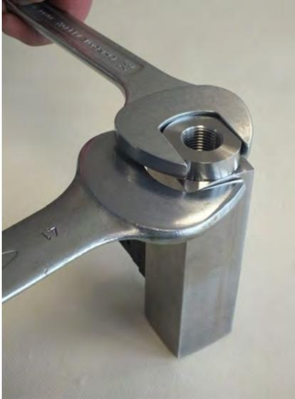
Abb. 41: Verschraubung (Eingang) lösen
