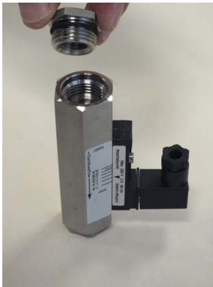
Abb. 42: Verschraubung (Eingang) abnehmen
