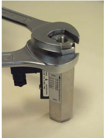
Abb. 34: Verschraubung (Ausgang) lösen
