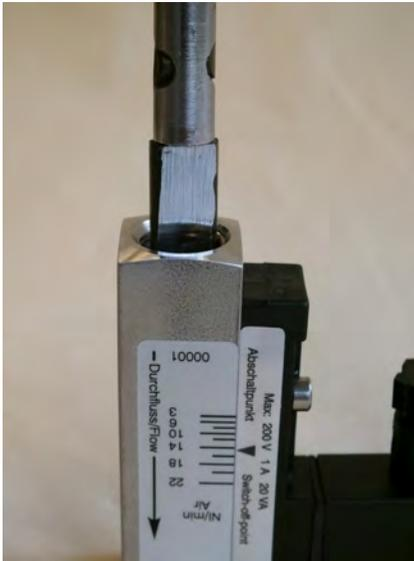
Abb. 40: Gewinding (Eingang) lösen
