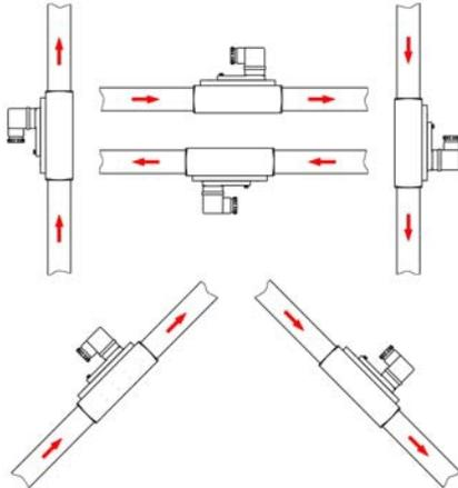
Abb. 5: Einbauposition/Durchflussrichtung
