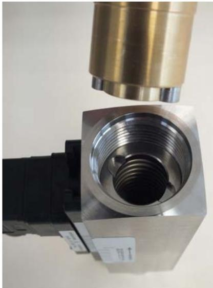
Abb. 42: Eindrehwerkzeug Gewinding (Eingang) einführen
