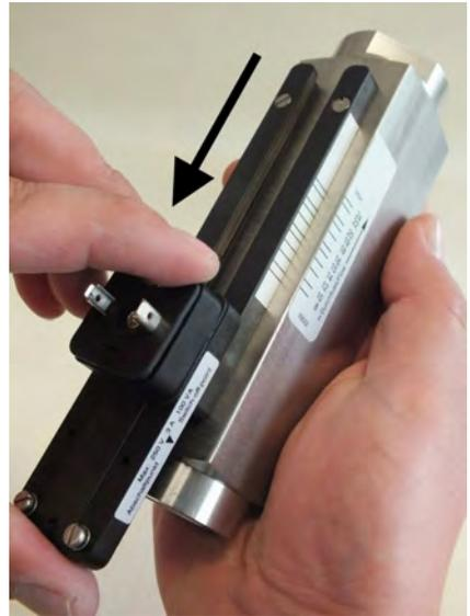
Abb. 62: Schaltkontakt aus Führung schieben
