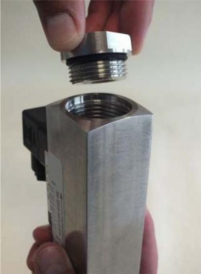
Abb. 34: Verschraubung (Ausgang) abnehmen
