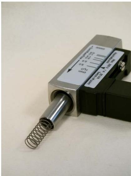
Abb. 37: Innenteile entnehmen
