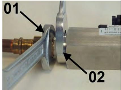
Abb. 12: Gerät einschrauben
