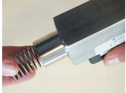
Abb. 39: Innenteile entnehmen
