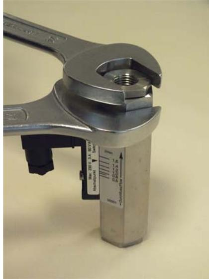
Abb. 52: Verschraubung (Ausgang) festziehen
