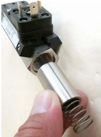
Abb. 36: Innenteile entnehmen
