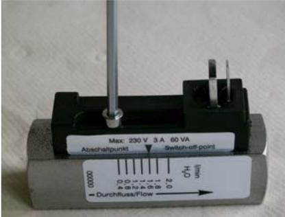
Abb. 51: Feststellschraube Schaltkontakt lösen
