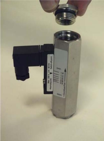
Abb. 51: Verschraubung (Ausgang) einsetzen
