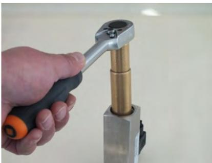
Abb. 44: Gewindering (Eingang) lösen
