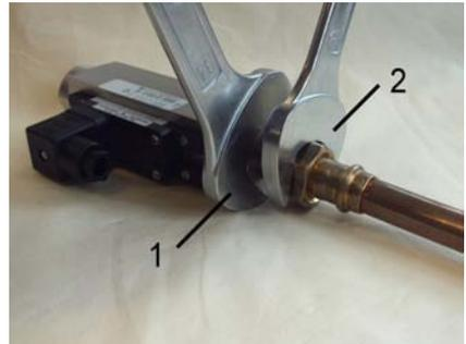
Abb. 11: Gerät einschrauben
