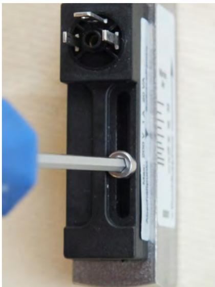
Abb. 51: Feststellschraube Schaltkontakt lösen
