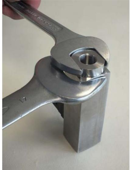
Abb. 50: Verschraubung (Eingang) festziehen
