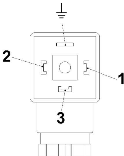
Abb. 15: Pin-Belegung Steckerdose Wechsler (Erde-Anschluss nicht genutzt)
