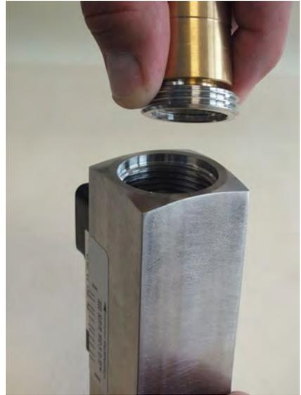
Abb. 54: Gewinding (Ausgang) einführen
