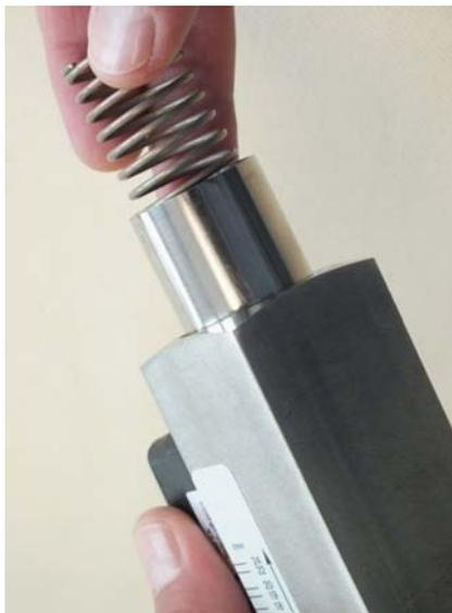
Abb. 38: Innenteile entnehmen
