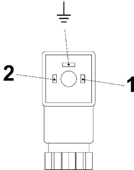
Abb. 13: Pin-Belegung Steckerdose Schließer (Erde-Anschluss nicht genutzt)
