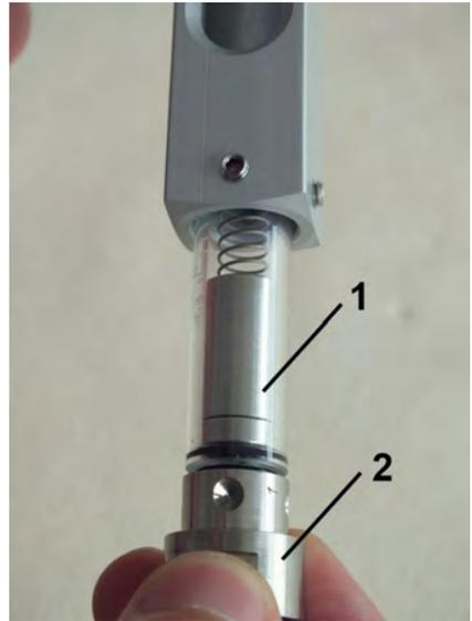
Abb. 37: Innenteile herausziehen
