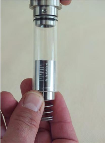
Abb. 39: Schwebekörper, Magnete und Feder entnehmen
