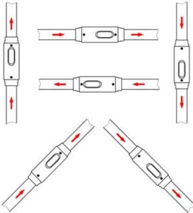
Abb. 5: Einbauposition/Durchflussrichtung
