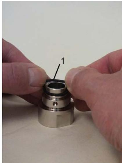
Abb. 38: O-Ring (Dichtung)
