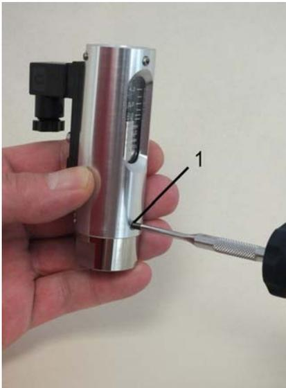
Abb. 35: Schrauben lösen
