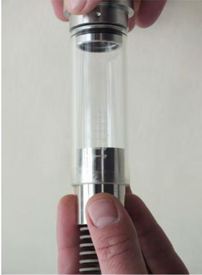
*Abb. 38: Schwebekörper, Magnete und Feder entnehmen*
