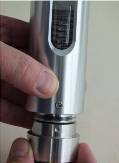
Abb. 45: Verschraubung in Gerätehülse schieben
