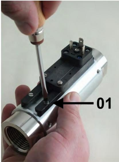
Abb. 55: Führungsleiste lösen
