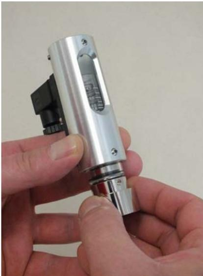
Abb. 44: Verschraubung in Gerätehülse schieben
