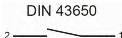
Abb. 13: Zustand des Kontaktes bei Gerät ohne Durchfluss
