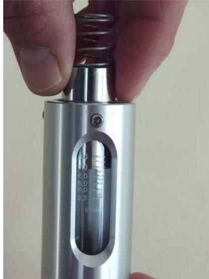
*Abb. 47: Innenteile einführen*
