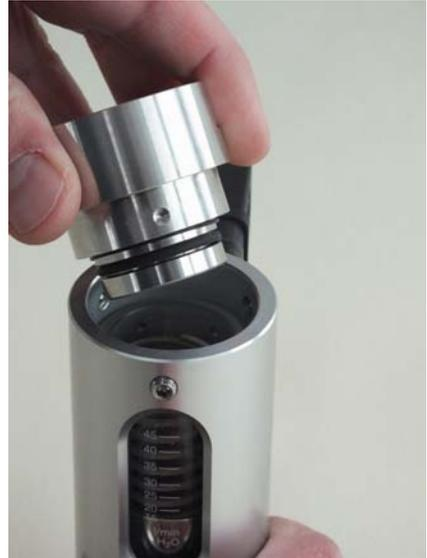
**Abb. 34: Verschraubung (Ausgang) abnehmen**
