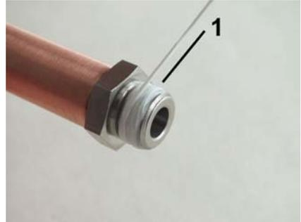
Abb. 8: Dichtfaden aufbringen
