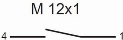
Abb. 17: Zustand des Kontaktes bei Gerät ohne Durchfluss
