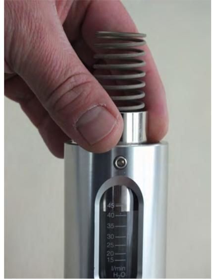
*Abb. 48: Innenteile einführen*
