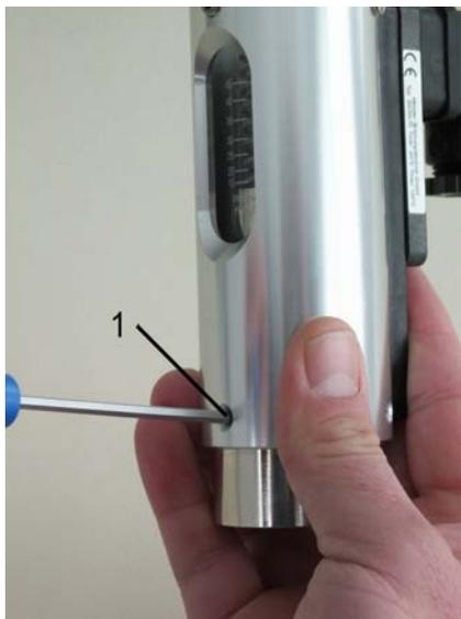
Abb. 35: Schrauben lösen
