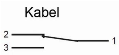
Zustand des Kontaktes bei Gerät ohne Durchfluss
