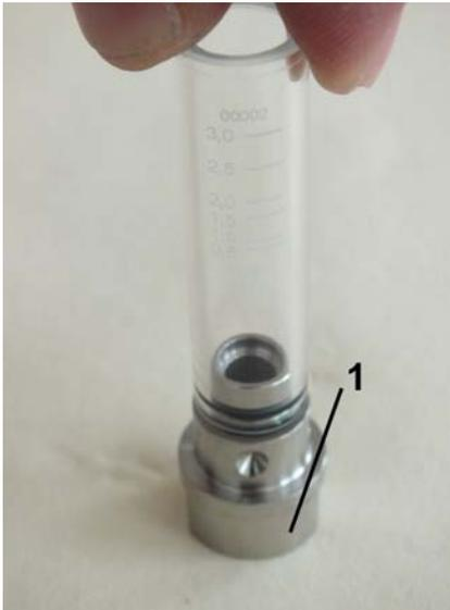
Abb. 42: Verschraubung (Eingang) in Schauglas
