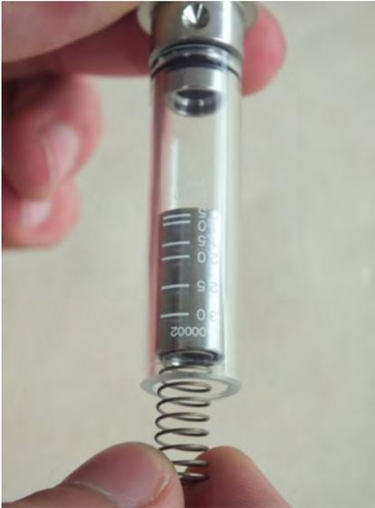
Abb. 38: Schwebekörper, Magnete und Feder entnehmen
