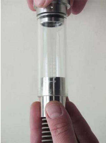
Abb. 37: Schwebekörper und Feder entnehmen
