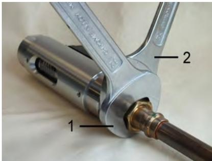
Abb. 11: Gerät einschrauben
