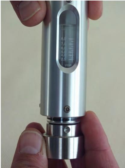
Abb. 46: Verschraubung in Gerätehülse schieben
