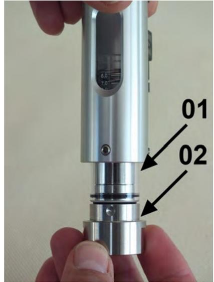
Abb. 38: Innenteile herausziehen
