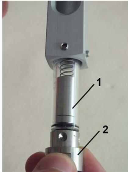
Abb. 36: Innenteile herausziehen
