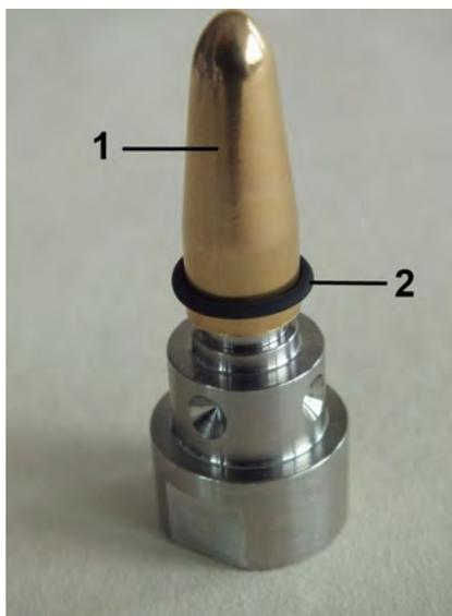
Abb. 39: O-Ring (Dichtung)
