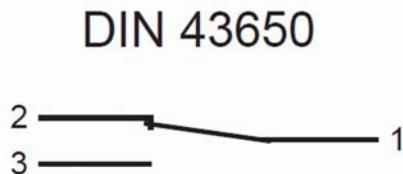
Abb. 14: Zustand des Kontaktes bei Gerät ohne Durchfluss
