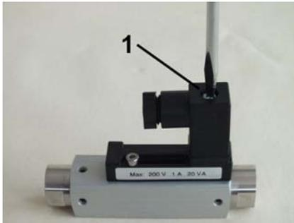
Abb. 19: Steckdose lösen
