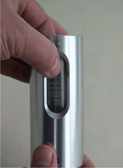
*Abb. 47: Schauglas ausrichten*
