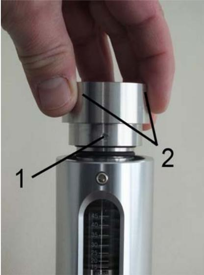
Abb. 48: Verschraubung (Ausgang) in Gerätehülse einsetzen
