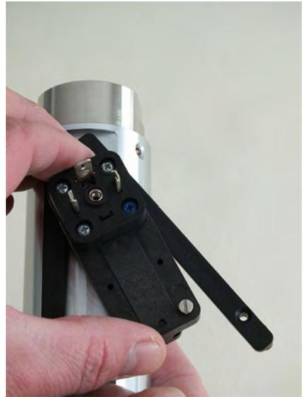
Abb. 56: Führungsleiste wegklappen
