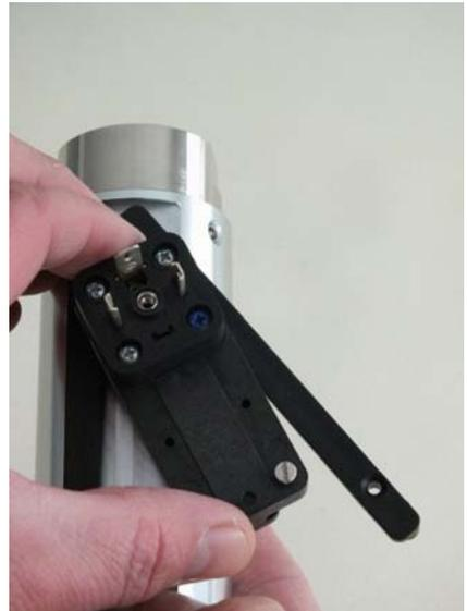
*Abb. 55: Führungsleiste wegklappen*
