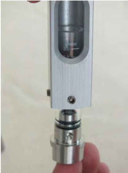
Abb. 45: Verschraubung in Gerätehülse schieben
