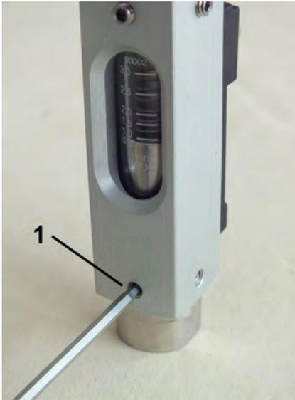
Abb. 36: Schrauben lösen
