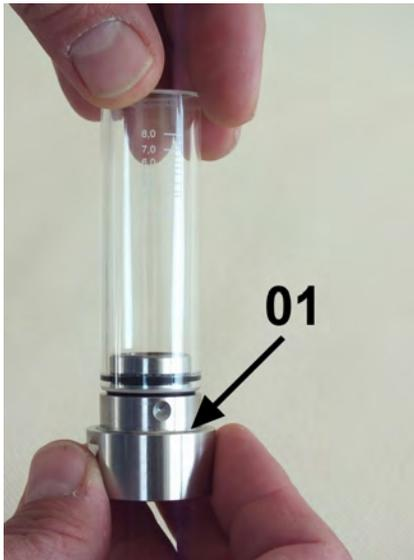
Abb. 44: Verschraubung (Eingang) in Schauglas
