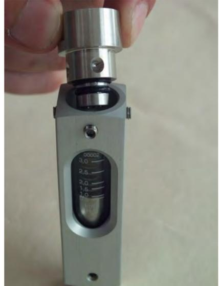
Abb. 35: Verschraubung (Ausgang) abnehmen
