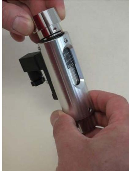
Abb. 34: Verschraubung (Ausgang) abnehmen
