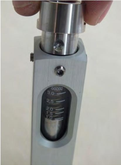
Abb. 49: Verschraubung (Ausgang) in Gerätehülse einsetzen
