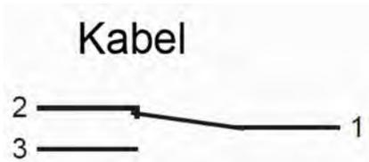
Zustand des Kontaktes bei Gerät ohne Durchfluss
