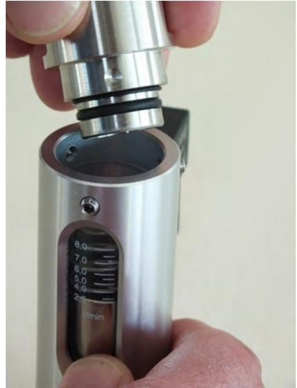
Abb. 36: Verschraubung (Ausgang) abnehmen
