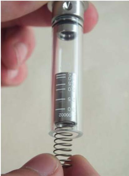
Abb. 37: Schwebekörper und Feder entnehmen
