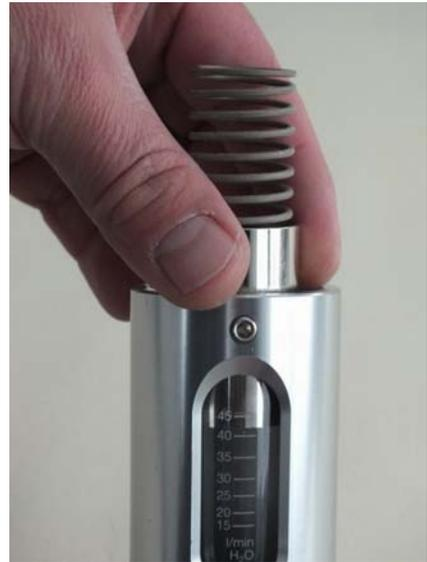
*Abb. 47: Innenteile einführen*
