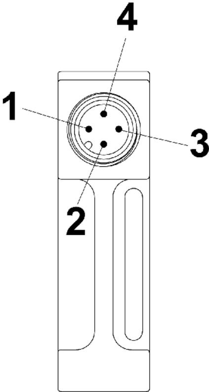
Abb. 16: Pin-Belegung Gerätestecker M12x1 (Form 15x50)
