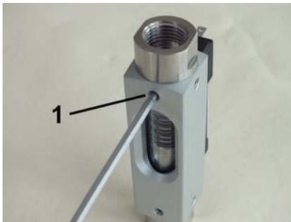
Abb. 33: Schrauben lösen
