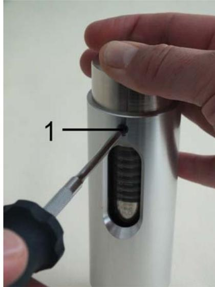
Abb. 49: Innensechskantschrauben anziehen
