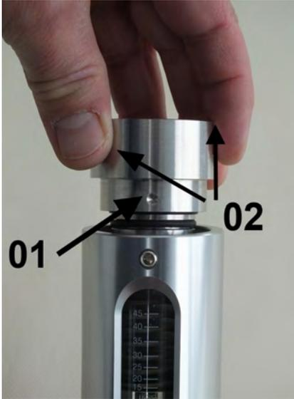
*Abb. 49: Verschraubung (Ausgang) in Gerätehülse einsetzen*
