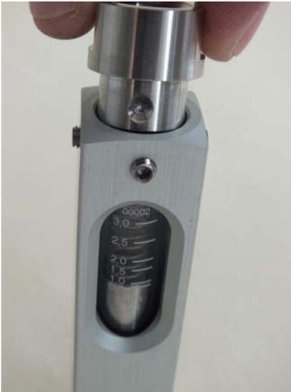
Abb. 48: Verschraubung (Ausgang) in Gerätehülse einsetzen
