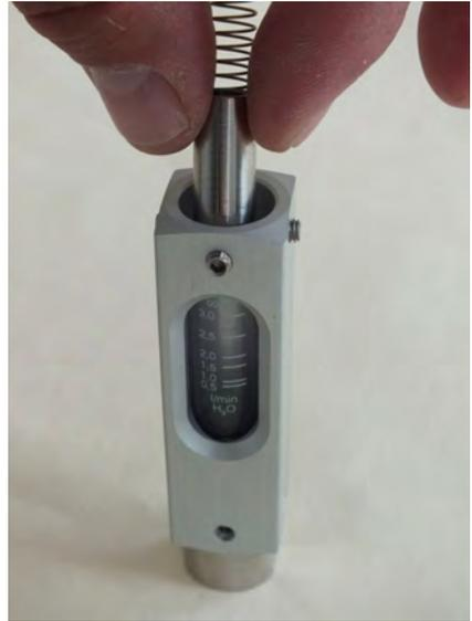
Abb. 48: Schwebekörper und Innenteile einführen
