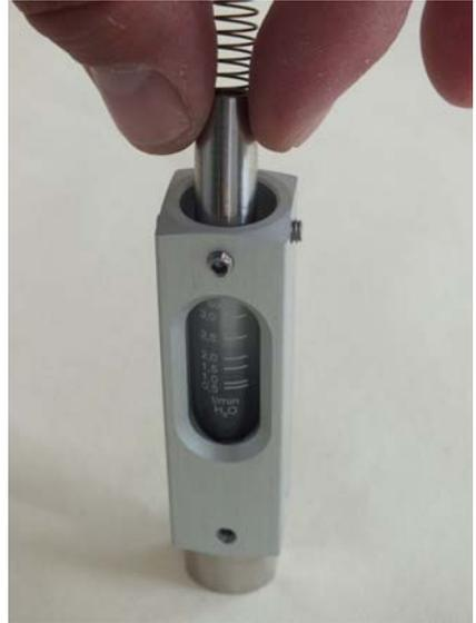
Abb. 47: Schwebekörper und Feder einführen
