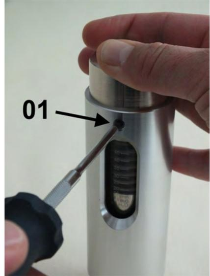
*Abb. 50: Innensechskantschrauben anziehen*
