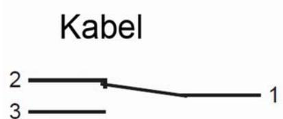
Zustand des Kontaktes bei Gerät ohne Durchfluss
