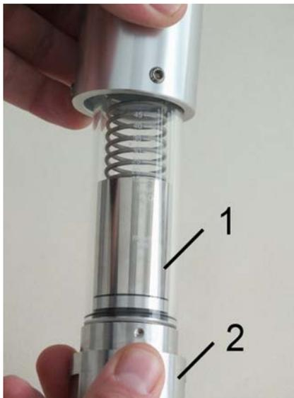
Abb. 36: Innenteile herausziehen
