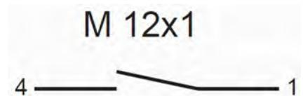
Abb. 18: Zustand des Kontaktes bei Gerät ohne Durchfluss
