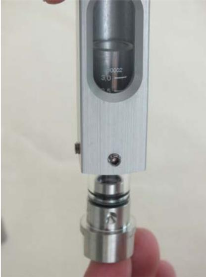
Abb. 44: Verschraubung in Gerätehülse schieben
