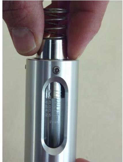
*Abb. 49: Schwebekörper und Innenteile einführen*
