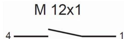
Abb. 17: Zustand des Kontaktes bei Gerät ohne Durchfluss
