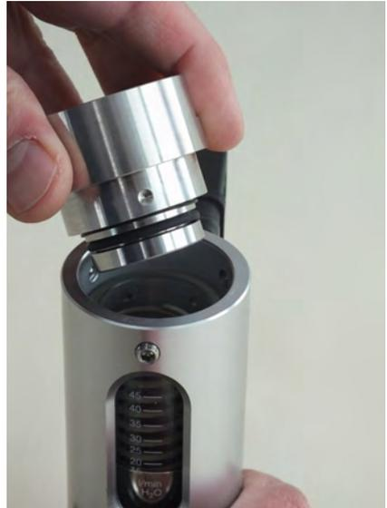
*Abb. 35: Verschraubung (Ausgang) abnehmen*
