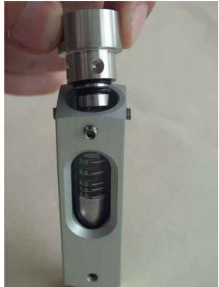
Abb. 34: Verschraubung (Ausgang) abnehmen
