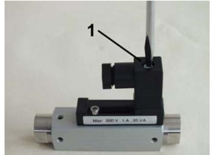
Abb. 51: Steckerdose lösen
