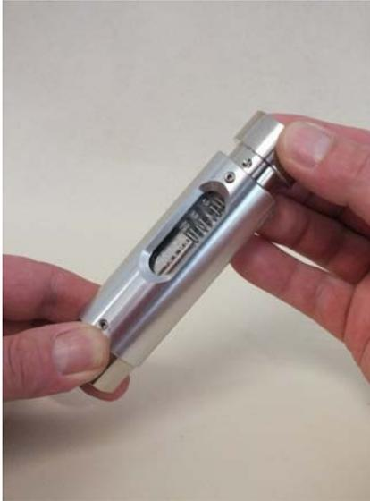
Abb. 48: Verschraubung (Ausgang) in Gerätehülse einsetzen
