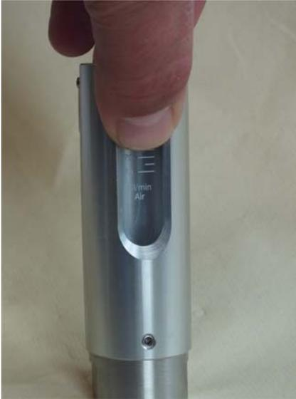
*Abb. 46: Schauglasskala ausrichten*
