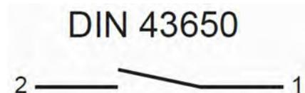
Abb. 13: Zustand des Kontaktes bei Gerät ohne Durchfluss
