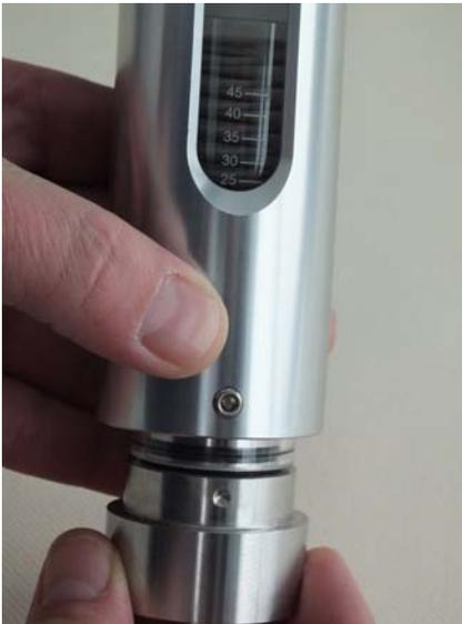
Abb. 44: Verschraubung in Geräte­hülse schieben
