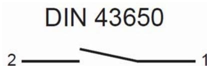
Abb. 12: Zustand des Kontaktes bei Gerät ohne Durchfluss
