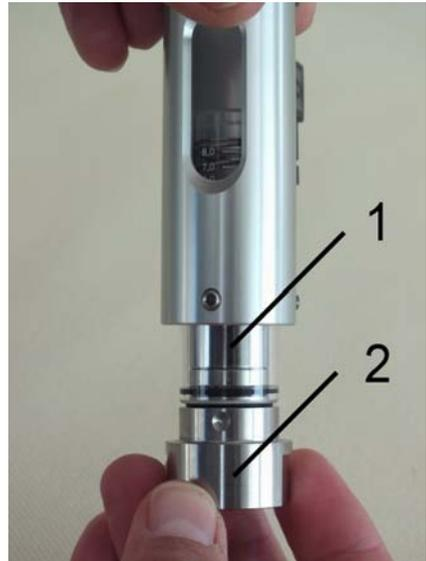
Abb. 36: Innenteile herausziehen
