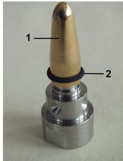
Abb. 38: O-Ring (Dichtung)
