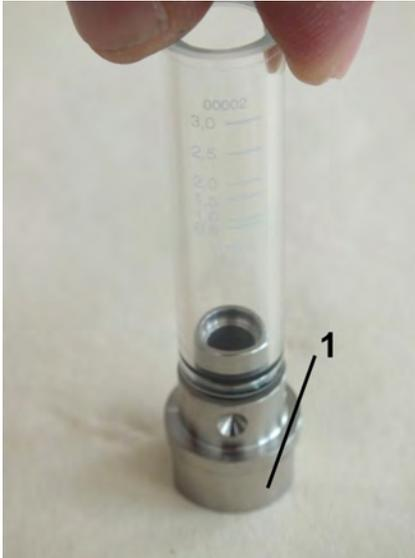
Abb. 43: Verschraubung (Eingang) in Schauglas
