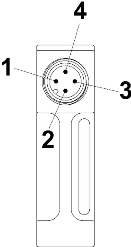
Abb. 17: Pin-Belegung Gerätestecker M12x1 (Form 30x70)
