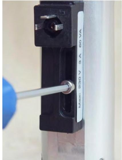
*Abb. 32: Feststellschrauben lösen*
