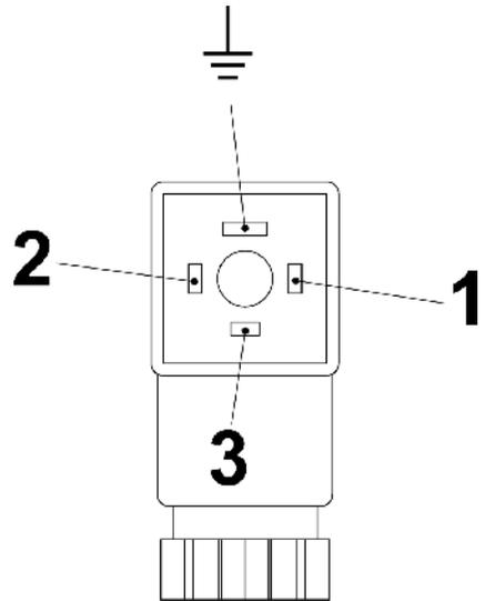
Abb. 15: Pin-Belegung Steckerdose Wechsler (Erde-Anschluss nicht genutzt)
