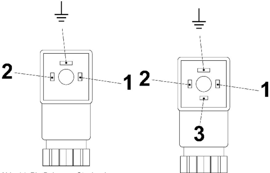
Abb. 14: Pin-Belegung Steckerdose Schließer (Erde-Anschluss nicht genutzt)
