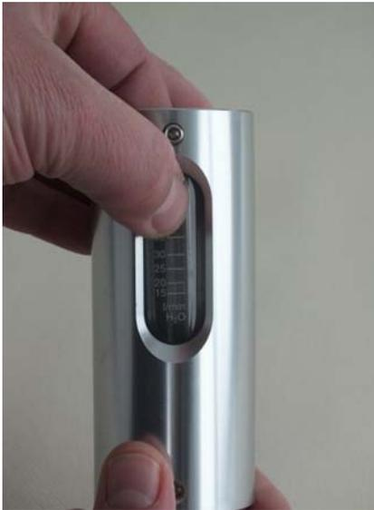
*Abb. 46: Schauglas ausrichten*
