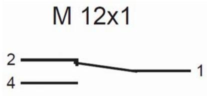
Abb. 18: Zustand des Kontaktes bei Gerät ohne Durchfluss
