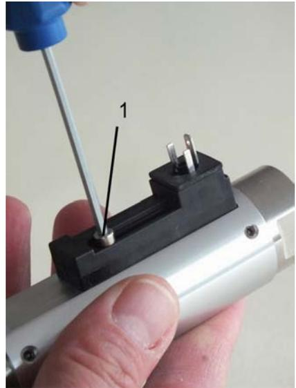
*Abb. 53: Feststellschraube lösen*
