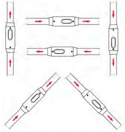
Abb. 5: Einbauposition/Durchflussrichtung
