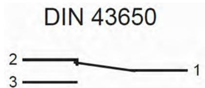
Abb. 15: Zustand des Kontaktes bei Gerät ohne Durchfluss
