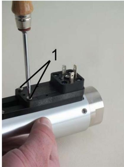
Abb. 53: Feststellschrauben lösen
