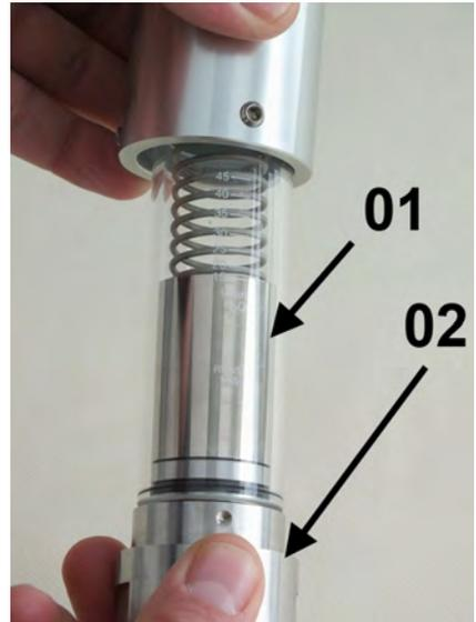
Abb. 37: Innenteile herausziehen
