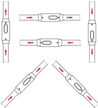
Abb. 5: Einbauposition/Durchflussrichtung
