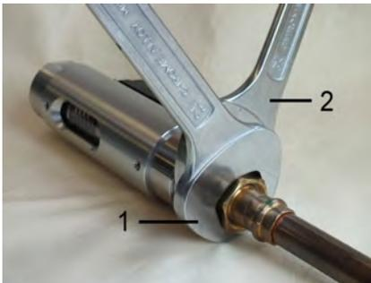
Abb. 11: Gerät einschrauben
