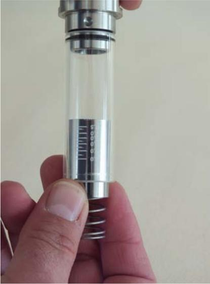
Abb. 37: Schwebekörper und Feder entnehmen
