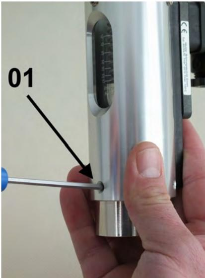
Abb. 36: Schrauben lösen
