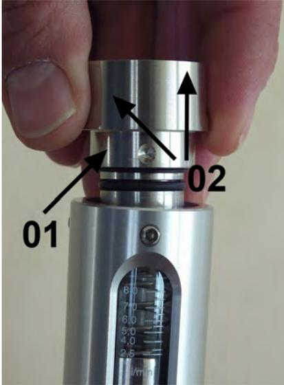
Abb. 50: Verschraubung (Ausgang) in Gerätehülse einsetzen
