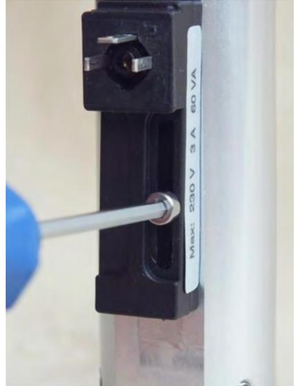
Abb. 33: Feststellschrauben lösen
