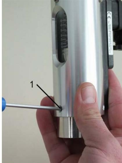
Abb. 45: Verschraubung (Eingang) befestigen
