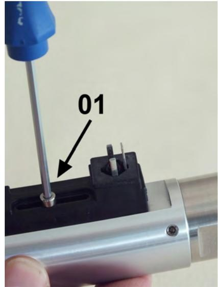
Abb. 55: Feststellschraube lösen
