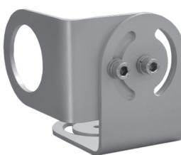
**Blasvorsatz aus Edelstahl:** Der Blasvorsatz schützt die Linse des Pyrometers in rauen Industriebedingungen vor Verschmutzung durch Staub, Feuchtigkeit oder Schwebstoffen und gewährleistet damit die einwandfreie Funktion des Gerätes. Der benötigte Luftdurchsatz liegt in etwa bei 25...30 l/min Druckluft unter 0,2...0,5 bar.
