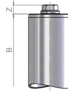
BC: Rohrboden mit Entlüftungsschraube G
